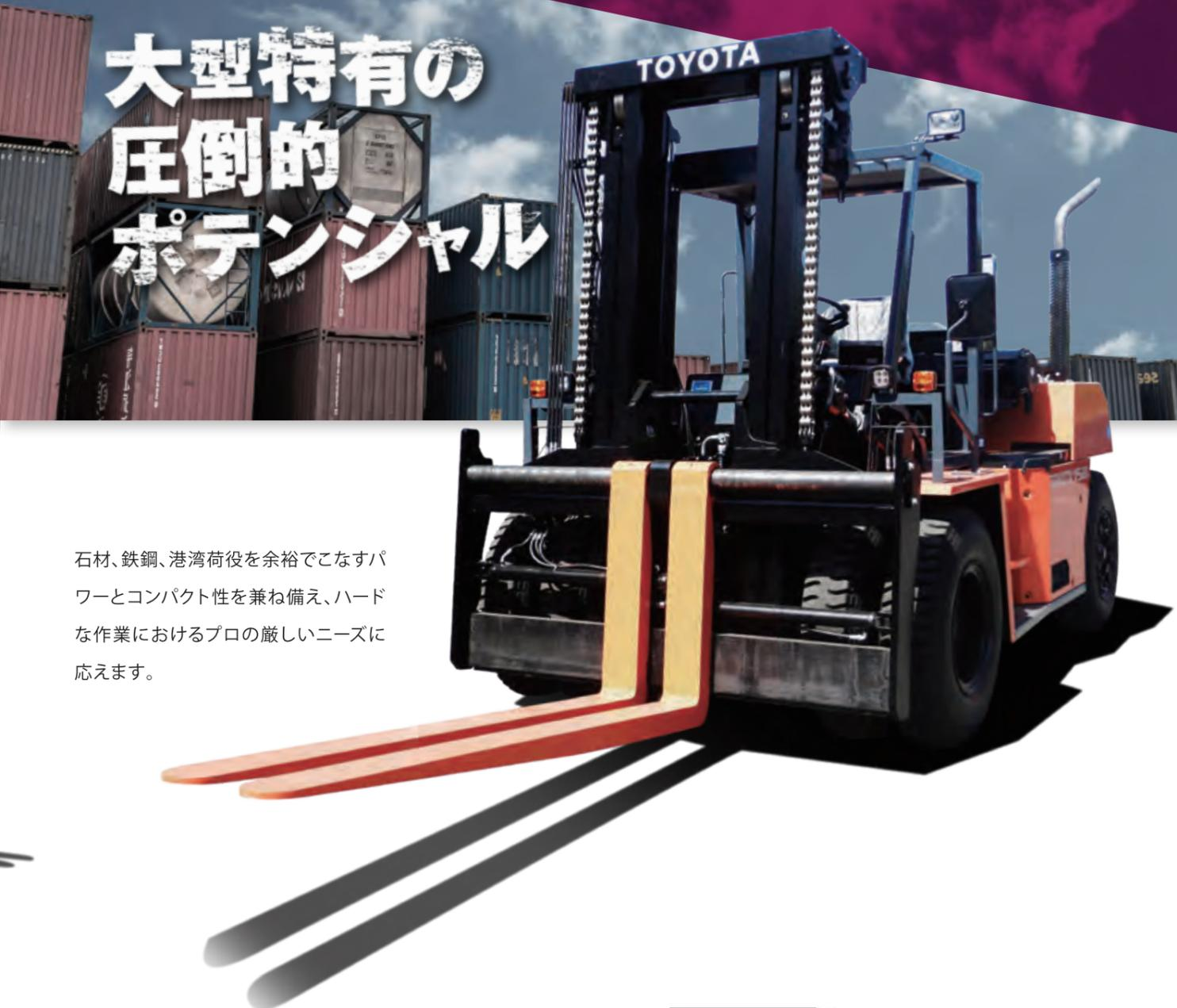
悪路や傾斜地のような地形で高い走破性を発揮する四輪駆動方式を採用し、大径タイヤと最適な重量配分により、高い安定性を確保しています。
